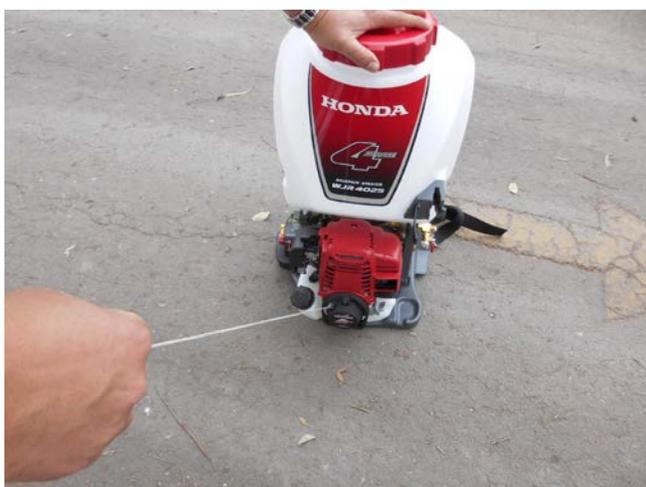
Si la palanca del estrangulador se ha puesto en la posición CERRADO para poner en marcha el motor, póngala gradualmente en la posición ABIERTO a medida que el motor se vaya calentando
