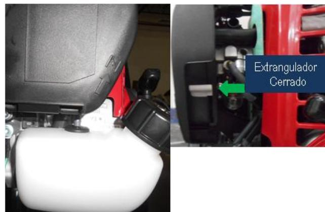
Para arrancar el motor cuando está caliente, deje la palanca del estrangulador en la posición ABIERTO.
