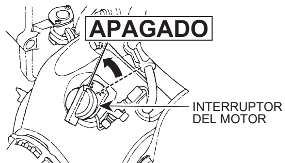
Figura 14. Interruptor de parada del motor (APAGADO)
