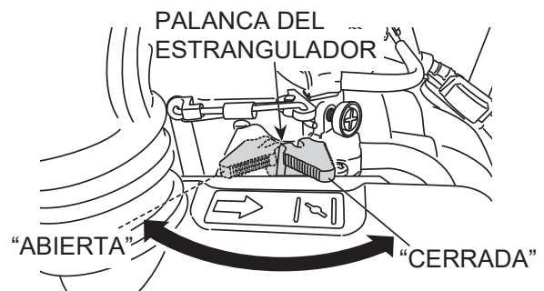
Figura 10. Palanca del estrangulador
