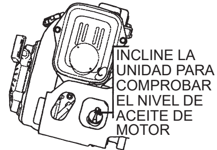
Figura 5. Inclinación de la máquina
