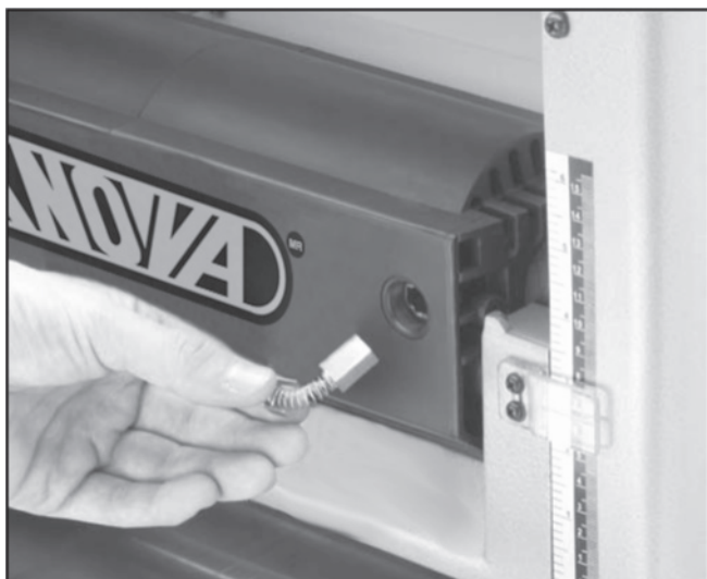
Figura 10. Área donde se sostiene el cepillo (del otro lado del motor existe otro cepillo aparte del que se muestra en la fotografía)
